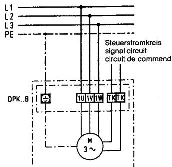
Mit Motorvollschutzschalter MV25
