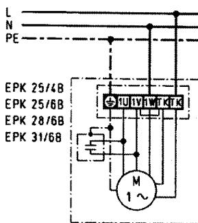
Mit Motorvollschutzschalter MVE10
