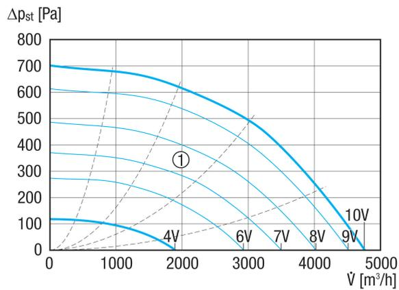
① Hilfskennlinien zu Steuerspannung 1 - 10 V
