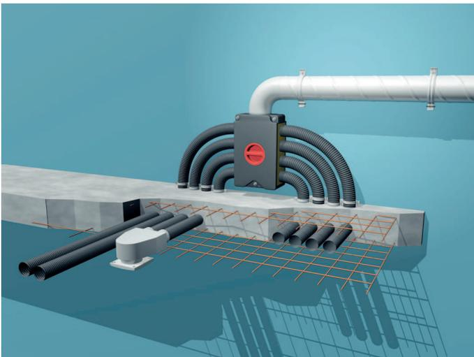
Für den Neubau empfiehlt sich das 63 mm Rohr, das besonders verformungssicher und stabil ist.
