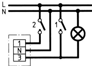
*Variante 2:* Beim Betätigen von Schalter 1 und 2 ist die Raumbelichtung sofort eingeschaltet, der Ventilator läuft nach ca. 45 Sekunden an.
