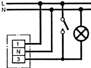
*Variante 2:* Über einen zusätzlichen Schalter kann der Ventilator unabhängig von der Feuchtesteuerung ein-/ausgeschaltet werden.
