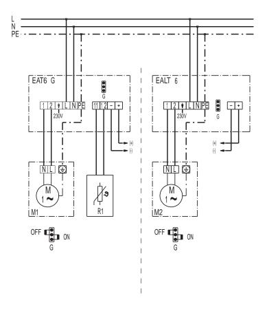
EAT 6 G - Temperaturregler R1 - Temperaturfühler M1 - Ventilator 1 EALT 6 - Leistungsteil M2 - Ventilator 2
