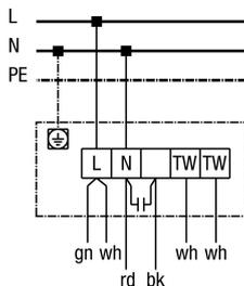
**Schallgedämmte Abluftbox EKR 20 und EKR 25 mit Motorvollschutzschalter MVE 10 und 5-Stufentransformator TRE ...**
