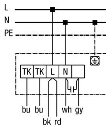
**Schallgedämmte Abluftbox EKR 31 und EKR 35 mit Motorvollschutzschalter MVE 10 und 5-Stufentransformator TRE ...**
