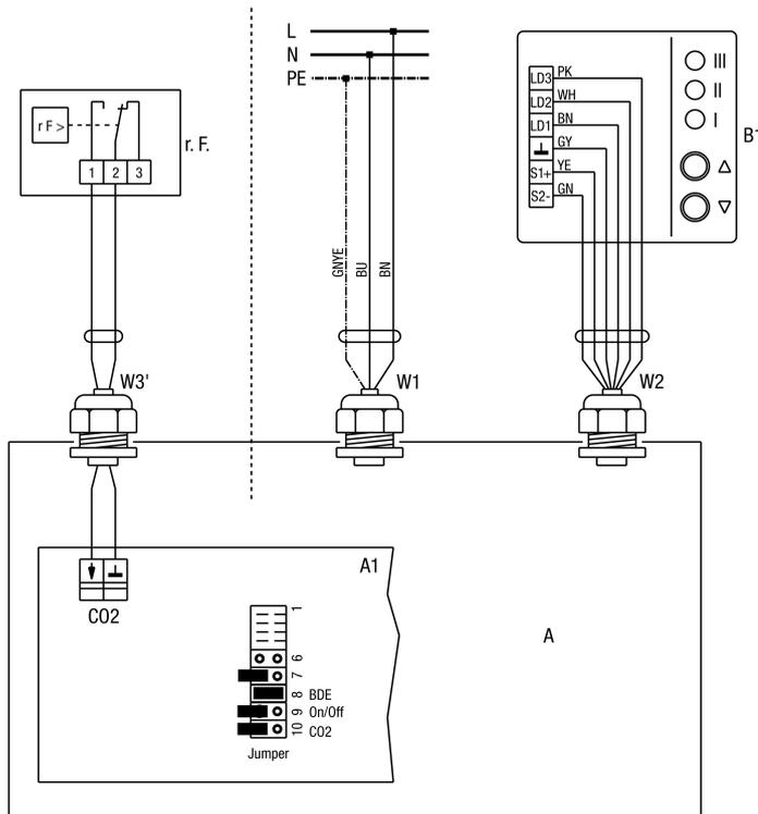
Anschluss eines Hygrostaten mit potentialfreiem Kontakt. Wenn bei Raumfeuchte der potentialfreie Kontakt im Hygrostat schließt, dann wird das Lüftungsgerät unabhängig von der eingestellten Luftstufe auf LS3 geschaltet. Wenn die Raumfeuchte abgebaut ist (Kontakt im Hygrostat öffnet) schaltet das Lüftungsgerät wieder auf die zuvor eingestellte Luftstufe zurück.
