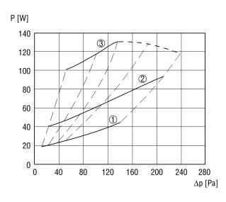
① Step 1: 100 m<sup>3</sup>/ h ② Step 2: 150 m<sup>3</sup>/ h ③ Step 3: 250 m<sup>3</sup>/ h
