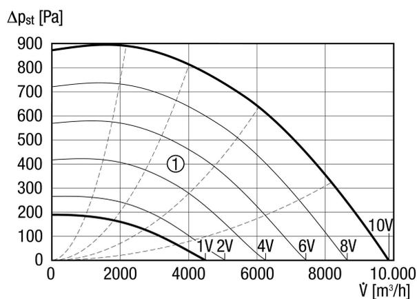
Courbes caractéristiques auxiliaires de tension de commande de 1 à 10 V
