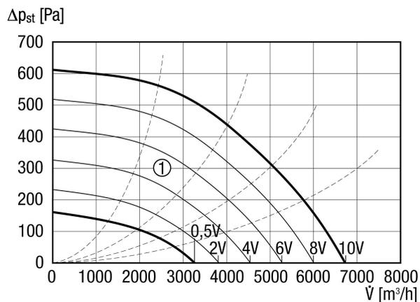
① Courbes caractéristiques auxiliaires de tension de commande de 0,5 à 10 V
