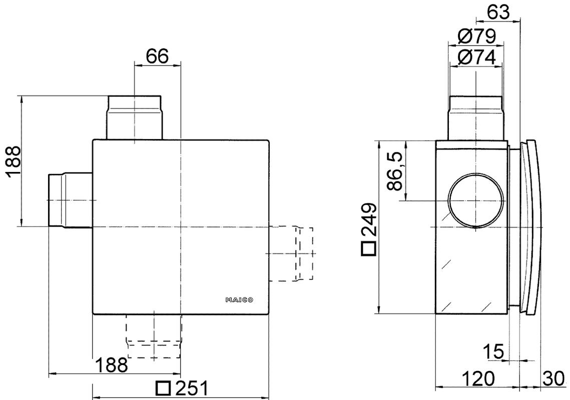
ER-UPB avec kit de raccordement pour pièce secondaire
