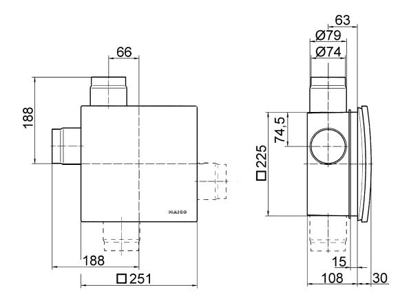
Insert de ventilateur ER avec boîtier encastré ER-UP/G ou ER-UPD et kit de raccordement pour pièce secondaire
