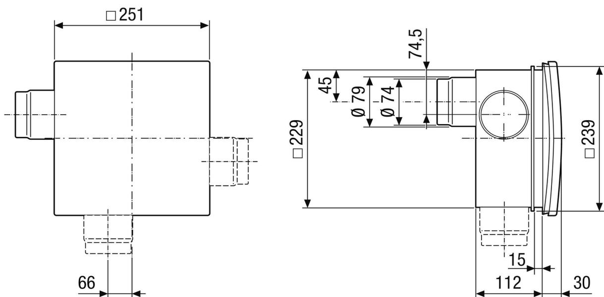
Insert de ventilateur ER ... E avec boîtier encastré ER-UP/GH et raccordement de pièce secondaire
