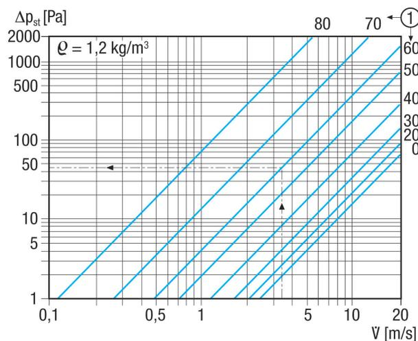
① Inclinaison des lamelles en degrés
