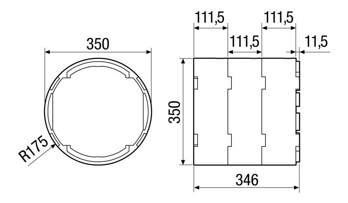
Diamètre de l'avant-trou de taraudage 360 mm
