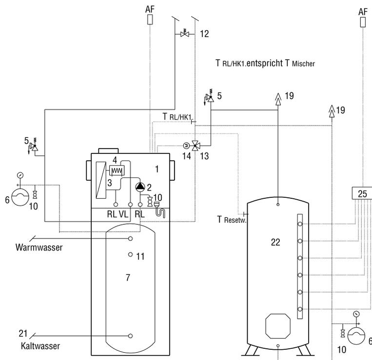
L'AWP peut être combinée avec un réservoir tampon. Il devient ainsi possible de profiter du tarif plus avantageux du courant de nuit ou d'utiliser d'autres sources d'énergie. La régulation de décharge est intégrée dans l'AWP.
