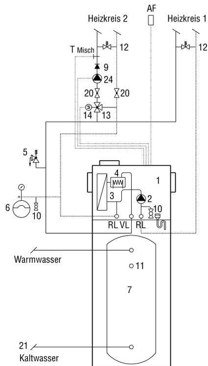
L'AWP est équipée en série pour la commande d'un deuxième circuit de chauffage à température de départ différente. Le client doit équiper le deuxième circuit de chauffage d'un servomoteur de mélangeur et d'une pompe de circulation.
