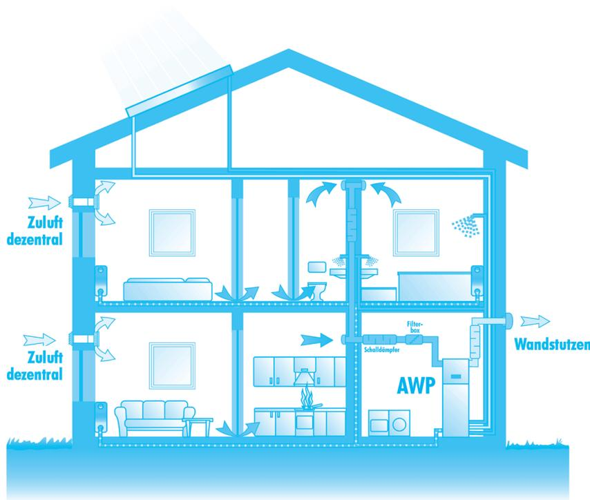
En présence de températures extérieures très basses ou d'un besoin en chauffage très élevé, le système AWP couvre les besoins calorifiques supplémentaires de l'équipement de chauffage à l'aide d'un chauffage d'appoint électrique intégré (réchauffage électrique).
