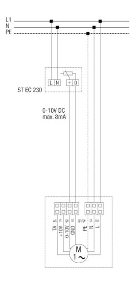
Protection et interrupteur général à fournir sur site TA - Tacho
