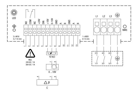
C - Controller NWS - vis réseau, max. 0,8 Nm, ne pas enlever
