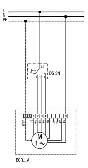
DS 3N - graduateur à 3 niveaux Les bornes 1 à 4 sont les bobinages du moteur. Revêtement des bornes comme exemple : La plus petite vitesse de rotation (borne 1) n'est pas utilisée ici.
