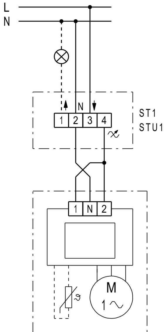
Régulateur de vitesse ST 1, montage apparent
