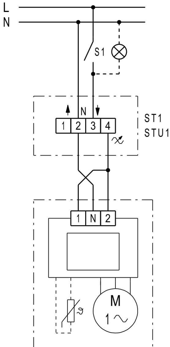
Régulateur de vitesse ST 1, montage apparent
