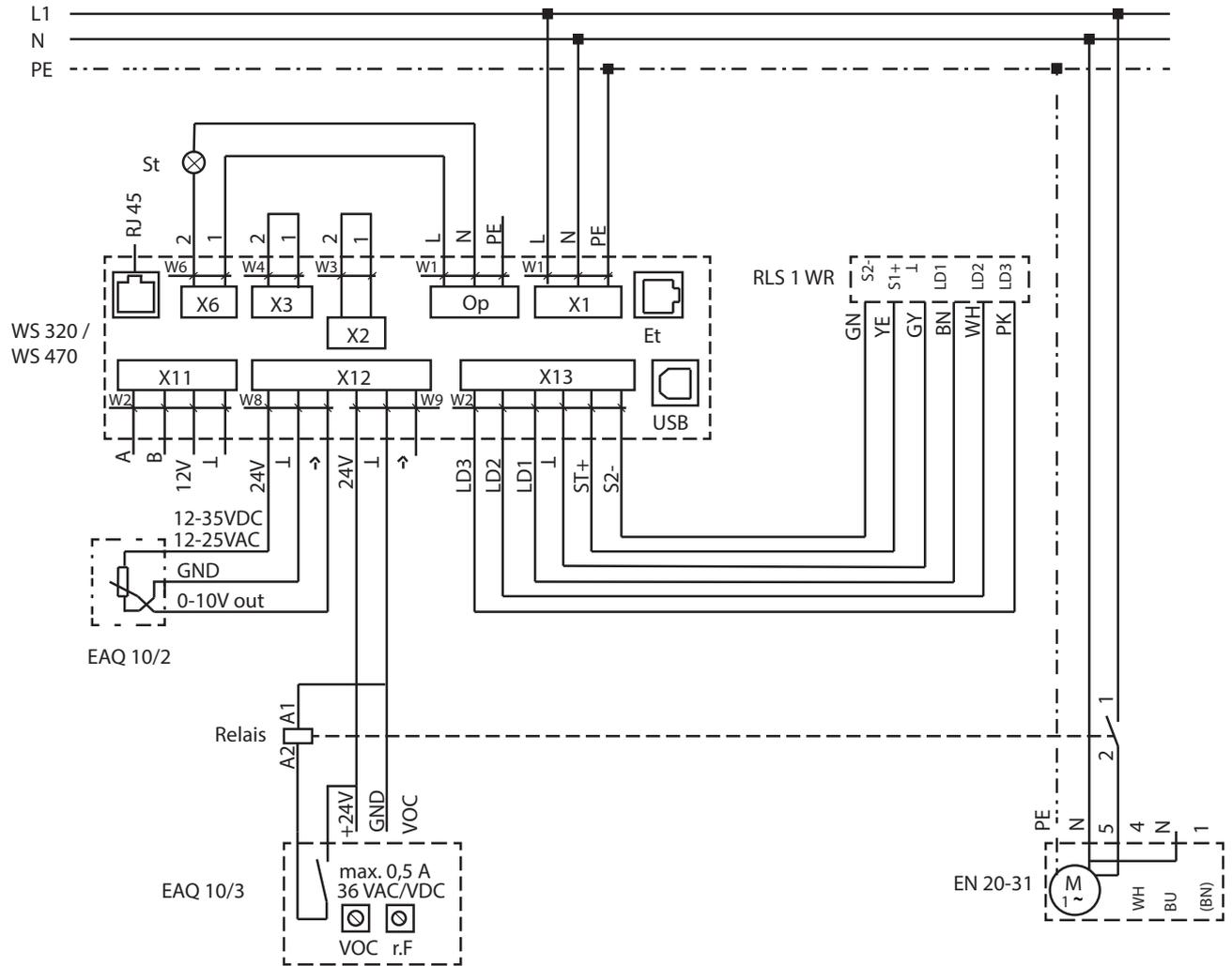
Dans le schéma de branchement, l'EAQ 10/3 fonctionne dans une cave de loisir avec un ventilateur mural encastrable EN.
