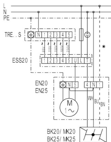
TRE..S - Transformateur à 5 plots (armoire électrique)
