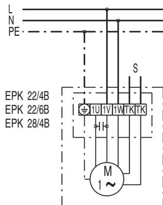
S = circuit électrique de commande pour la signalisation des défauts
