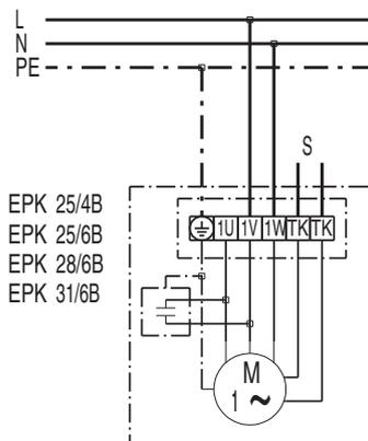
S = circuit électrique de commande pour la signalisation des défauts
