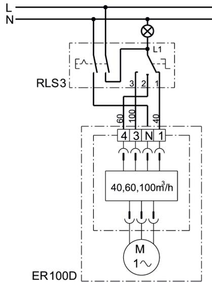
RLS 3 - Commande air ambiant avec position zéro et interrupteur pour l'éclairage de la pièce
