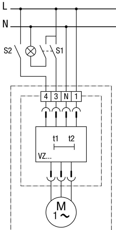
Le ventilateur bascule automatiquement en charge pleine après 50 secondes environ lorsque la pièce est utilisée (S1 = Marche). L'interrupteur S2 permet de désactiver manuellement le fonctionnement en charge de base.
