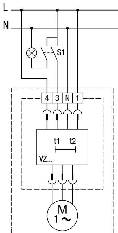
Le ventilateur fonctionne toujours en charge de base. Le ventilateur bascule automatiquement en charge pleine après 50 secondes environ lorsque la pièce est utilisée (S1 = Marche).
