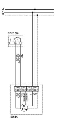
Protection et interrupteur général à fournir sur site Allumer et éteindre le caisson de ventilation uniquement au-dessus de 0-10 volts
