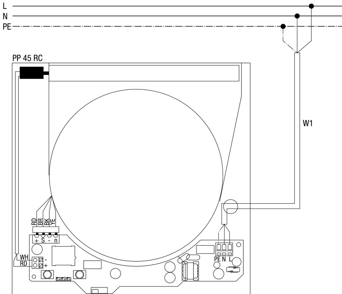
PP 45 RC - Appareil de ventilation PP 45 RC
