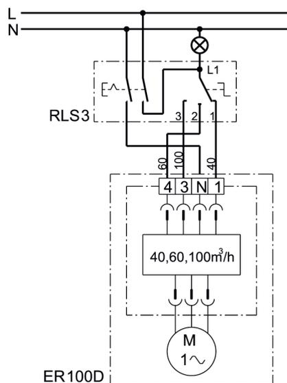
RLS 3 - Commande air ambient avec position zéro et interrupteur pour l'éclairage de la pièce
