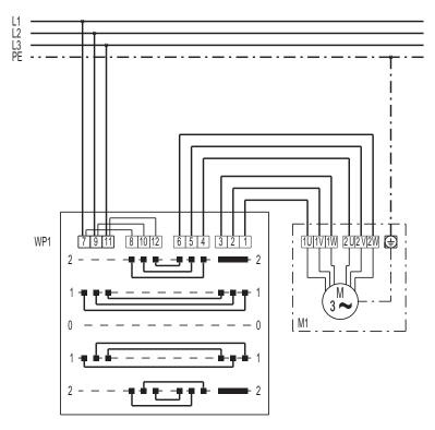
WP1 Inverseur de polarité : niveau 2/niveau 1/arrêt/niveau 1/niveau 2 M1 Ventilateur (moteur Dahlander)
