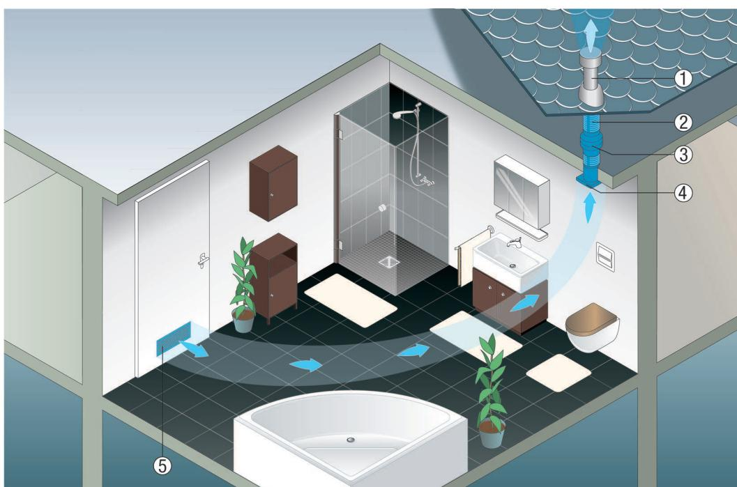
① Krovna kapa DN 125, reduktor na DN 100 trebaju se nabaviti na mjestu ugradnje
