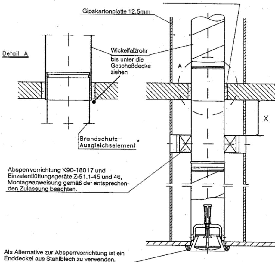
Absperrvorrichtung K90-18017 und Einzelentlüftungsgeräte Z-51.1-45 und 46, Montageanweisung gemäß der entsprechenden Zulassung beachten.
