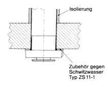
2 Ventilatoren Typ ECA 11 E in Rohrleitung DN 100
