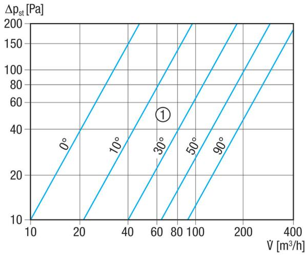
① Угол открытия пластинок
