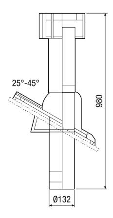
DF 125 c DP 125 TF/SF/TB/SB Для наклонной крыши
