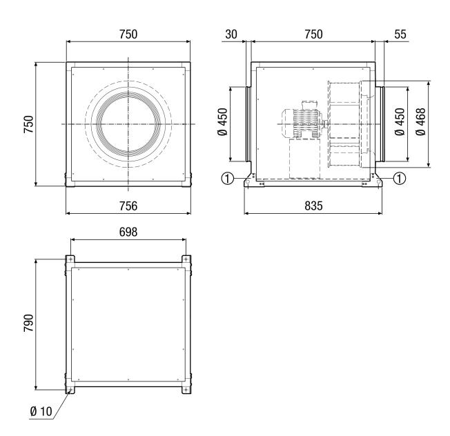
① Монтажные уголки и крепёжный материал входят в объём поставки
