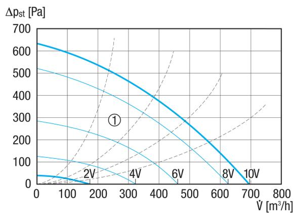
① Вспомогательные графические характеристики управляющего напряжения 2-10 В
