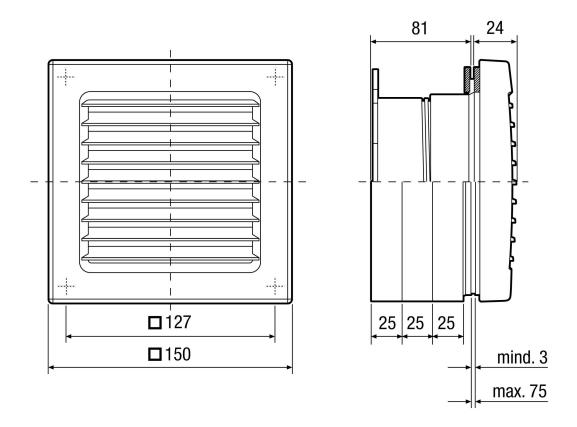
Отверстие в оконном стекле  $\emptyset$  от 115 до 120 мм
