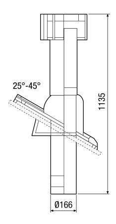
DF 160 S c DP 160 SB Для наклонной крыши
