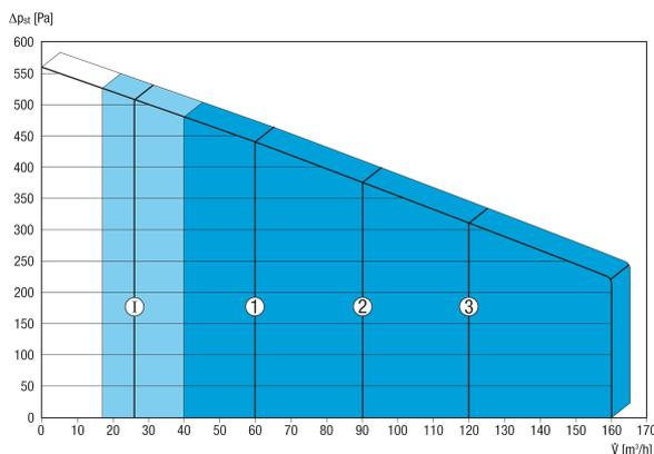
Приведенные цифры обозначают установленные ступени вентиляции ("заводские настройки").
