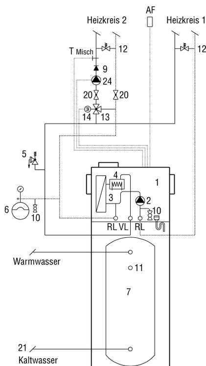
AWP серийно оснащается для управления вторым контуром нагревателя с другой температурой прямого потока. Второй контур нагревателя конструктивно должен быть оснащен сервомотором смешивания и циркуляционным насосом.
