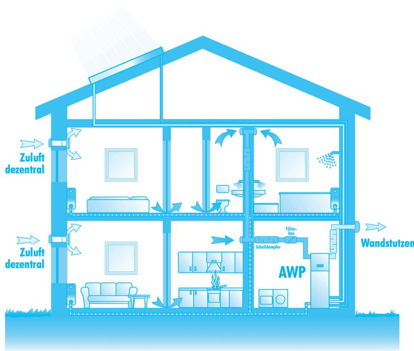
При очень низких наружных температурах или очень высокой потребности в тепле тепловой насос вытяжки покрывает потребность в остаточном тепле, возникающую в отопительной установке, при помощи встроенного дополнительного электроотопления (дополнительный электроподогрев).
