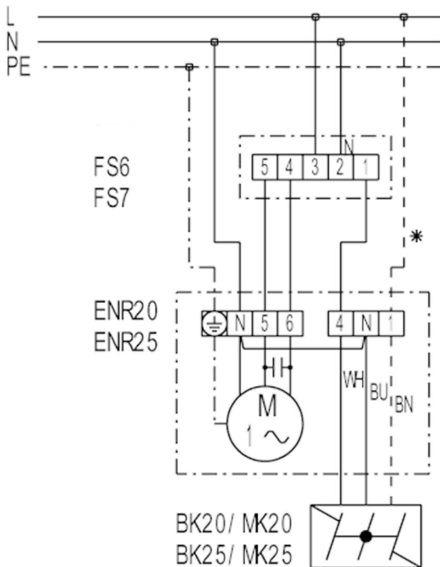
S1 ВКЛ/ВЫКЛ вентилятор (обеспечивается заказчиком)
