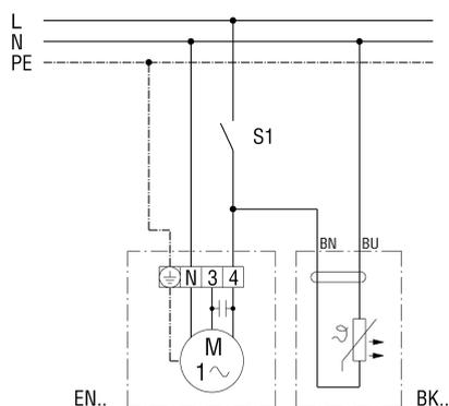
S1 ВКЛ/ВЫКЛ вентилятор (обеспечивается заказчиком)
