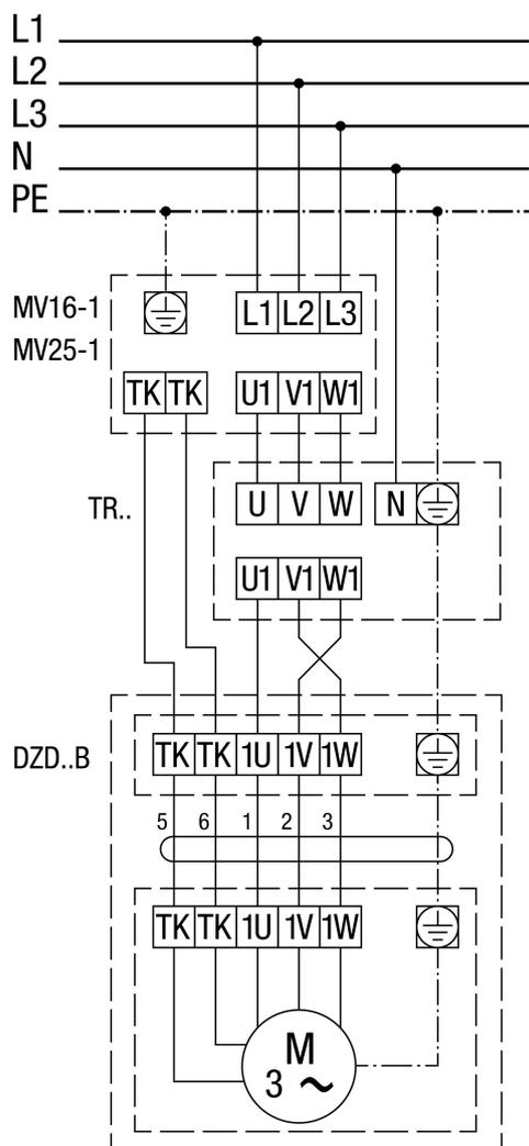
Вращение против часовой стрелки (вытяжная вентиляция) = стандартное исполнение
