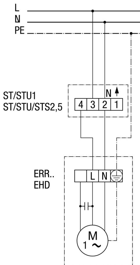
Центробежный вентилятор с 5-ступенчатым трансформатором TRE
