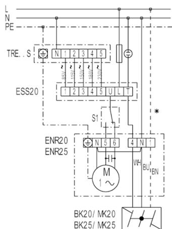
TRE - 5-ступенчатый трансформатор, монтаж в шкафу управления
