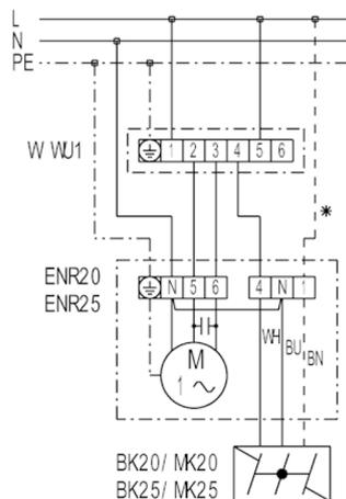
W 1 - реверсивный переключатель (вытяжная/ приточная вентиляция, ВКЛ/ВЫКЛ), настенный монтаж
