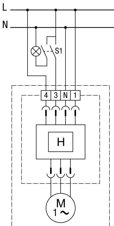
Вентилятор работает постоянно с базовой нагрузкой. При влажности выше значения для включения вентилятор автоматически переключается на полную нагрузку. Дополнительно выключателем S1 можно включить полную нагрузку вручную.
