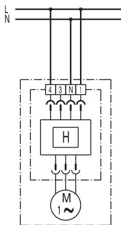
Вентилятор работает постоянно с базовой нагрузкой. При влажности выше значения для включения вентилятор автоматически переключается на полную нагрузку.
