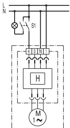
Вентилятор включается выключателем S1 вручную на базовую нагрузку. При влажности выше значения для включения вентилятор автоматически переключается на полную нагрузку.
