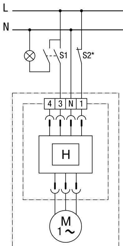
Вентилятор включается и выключается выключателем S1 вручную. Вентилятор выбегает до тех пор, пока влажность воздуха в помещении не упадет ниже значения для выключения.
