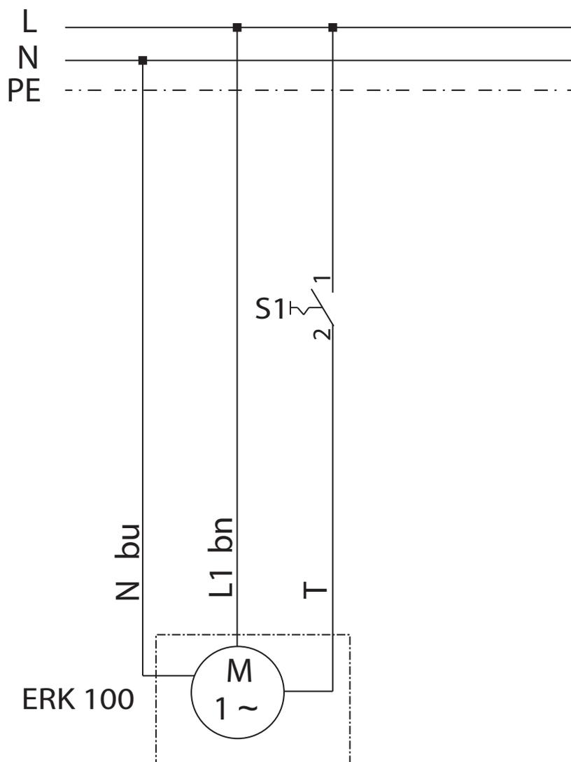
S1 - выключатель прибора
