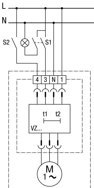
При использовании помещения (S1=VKL) через ок. 50 секунд вентилятор самостоятельно переключается на полную нагрузку. Выключателем S2 можно выключать режим базовой нагрузки вручную.
