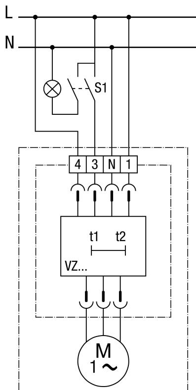
Вентилятор работает постоянно с базовой нагрузкой. При использовании помещения ( $S1=ВКЛ$ ) через ок. 50 секунд вентилятор самостоятельно переключается на полную нагрузку.
