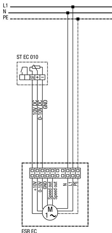
Предохранитель и главный выключатель устанавливаются заказчиком
